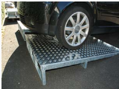
Rampe für Bremsprüfstand
